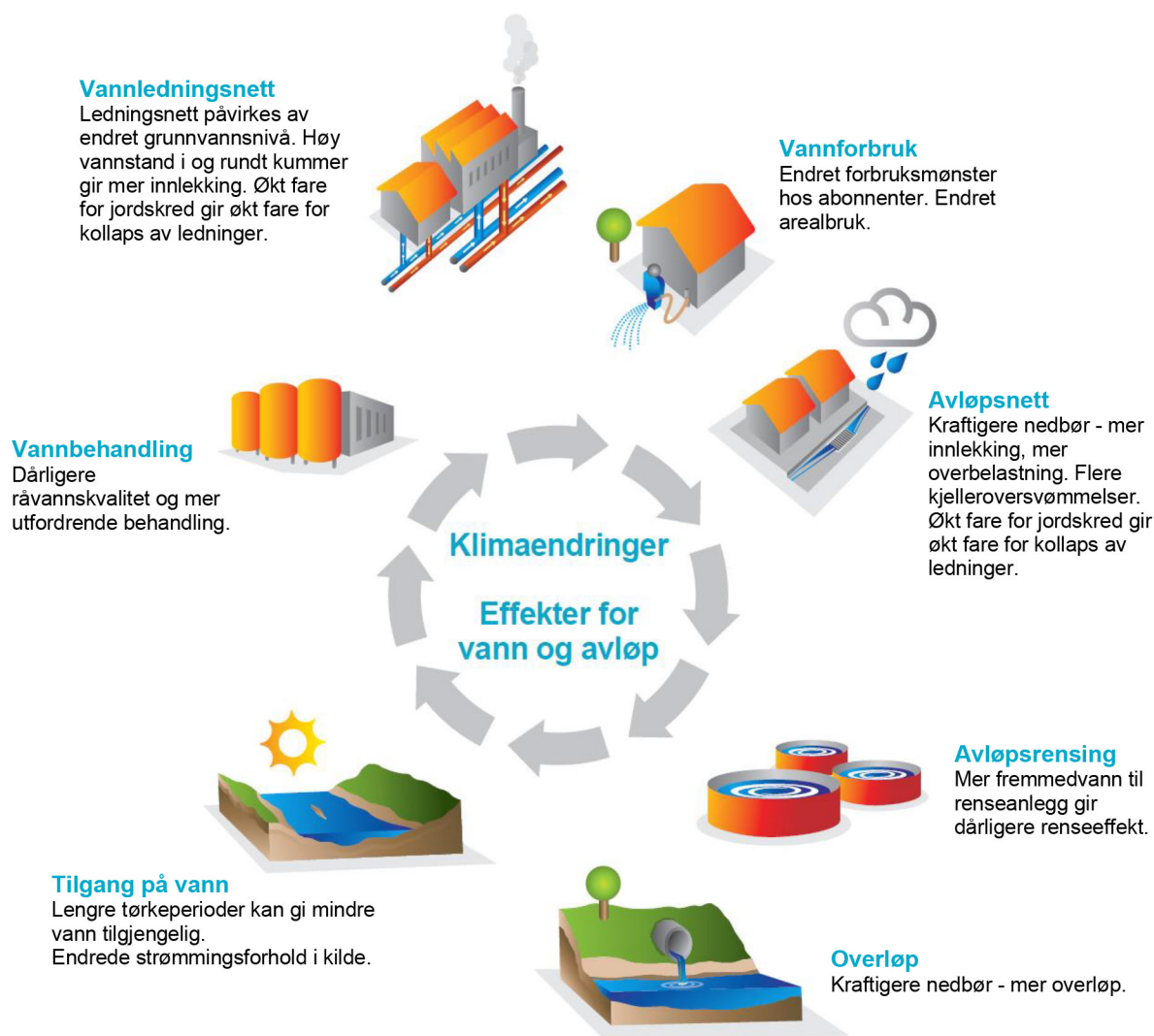
Figur 43 Klimaendringer – Effekter for vann og avløp
