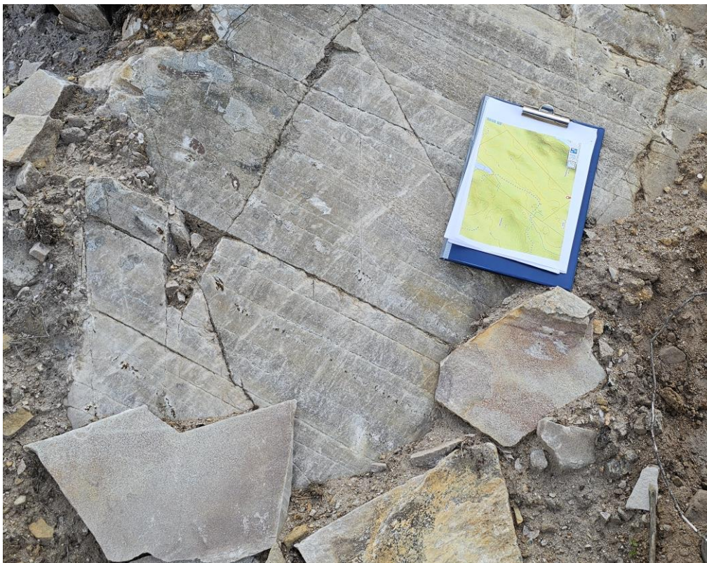
Fig 6. Fra eksisterende brudd. Tett laminasjon som dette gir mulighet for splitting av heller men ødelegges dels av sprekker på tvers. Ikke vanlig i forekomsten.
