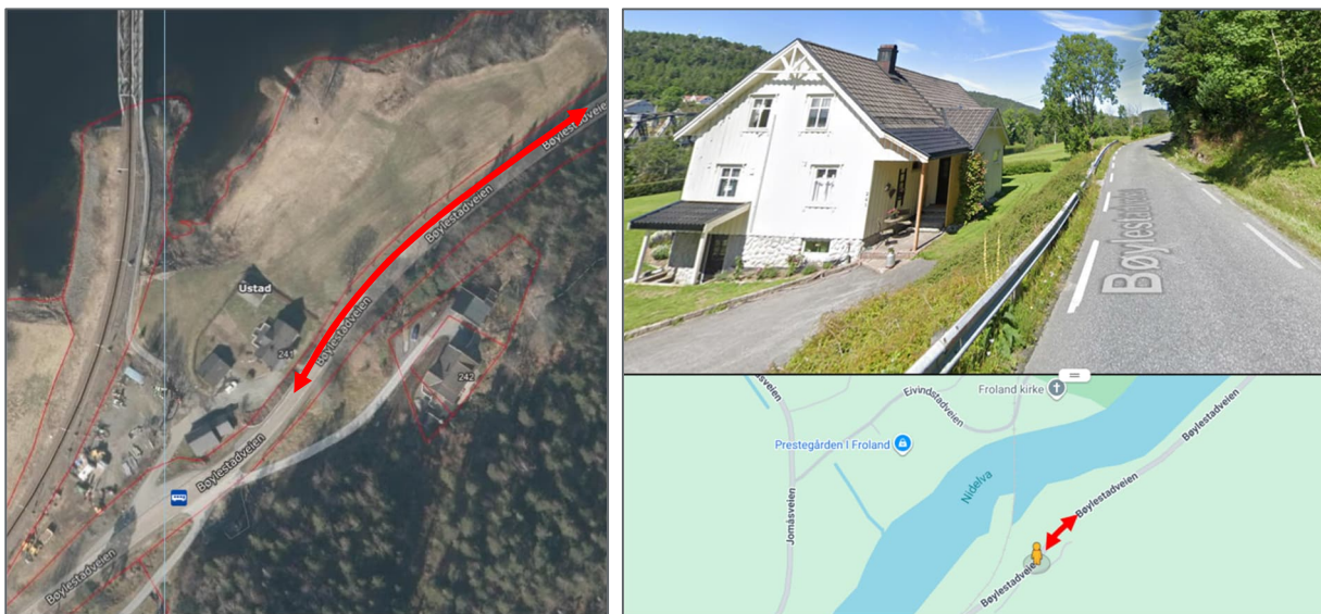
Figur 3-13: Smal kjørebane uten møteplass og dårlig sikt i kurve. I denne kurven har det skjedd en politirapportert trafikkuulykke over den siste tiårsperioden.
